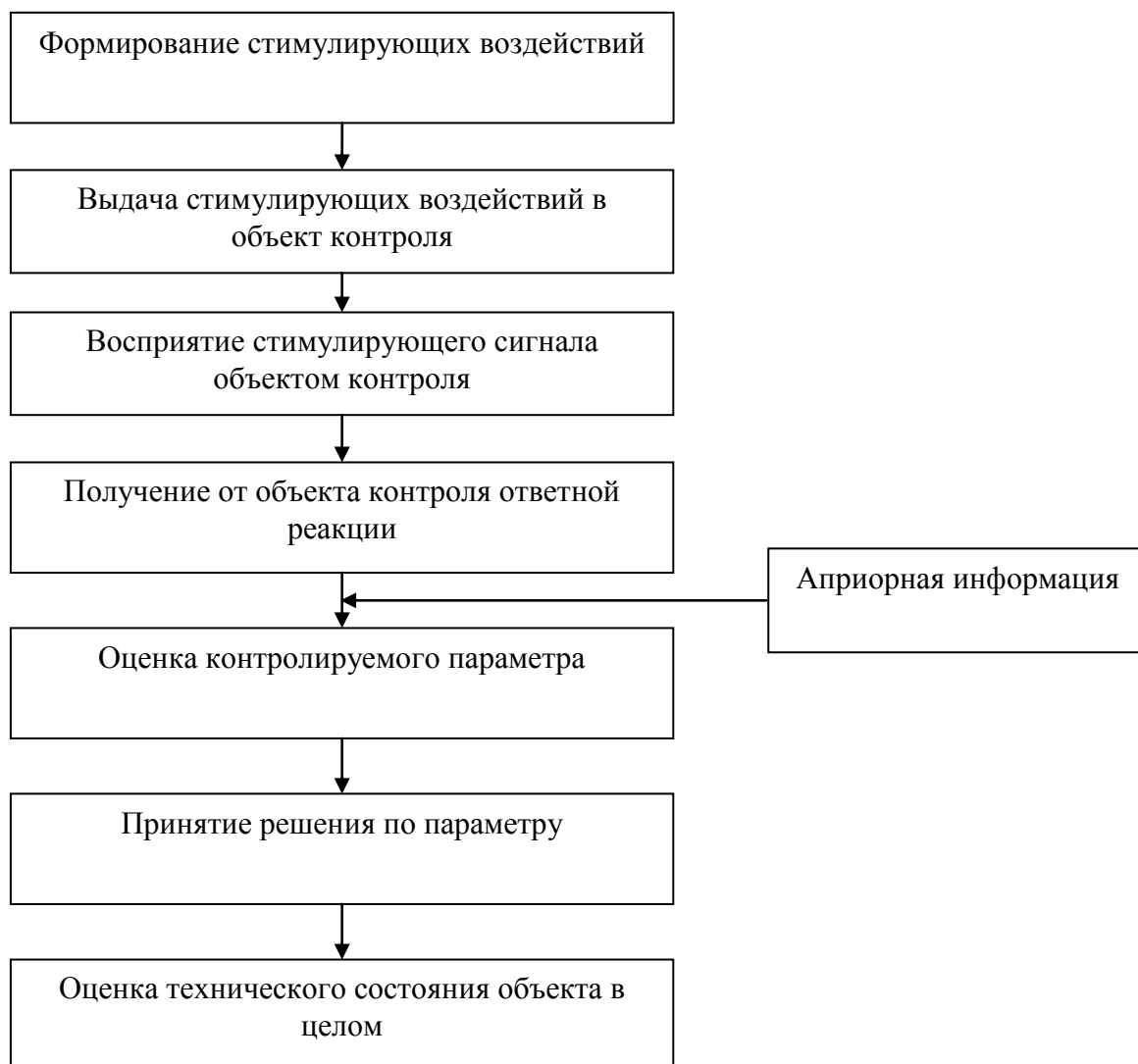
Рисунок 5.3 – Схема проверки технического состояния объекта контроля
